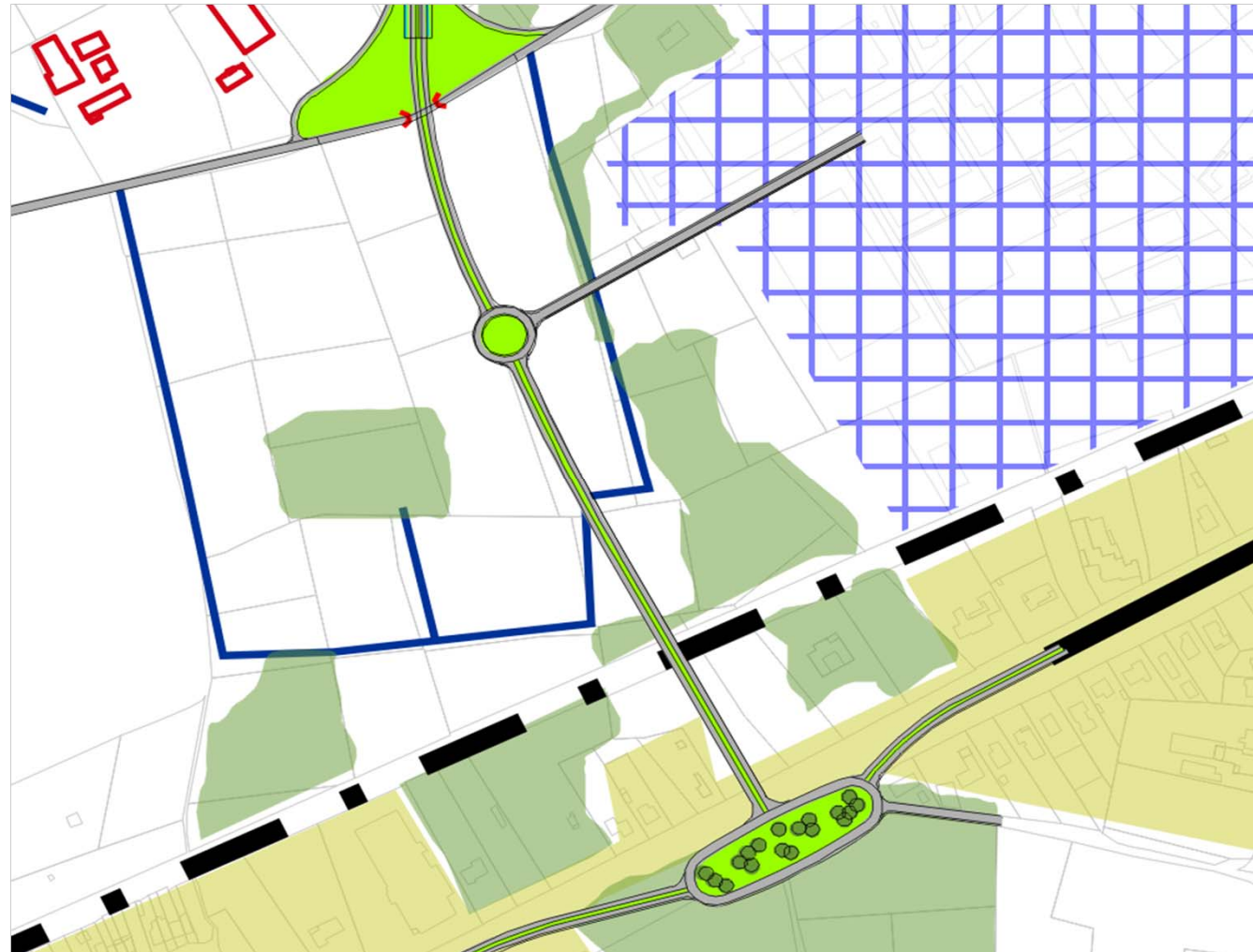
Aansluiting Doornpark en ongelijkvloerse kruising fiets Boerenstraat
