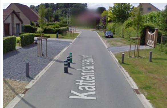
Figuur 19: Wegversmalling dmv geheugenpaal (Kattendansstraat Hasselt), fietsers kunnen rechts van de paaltjes passeren
