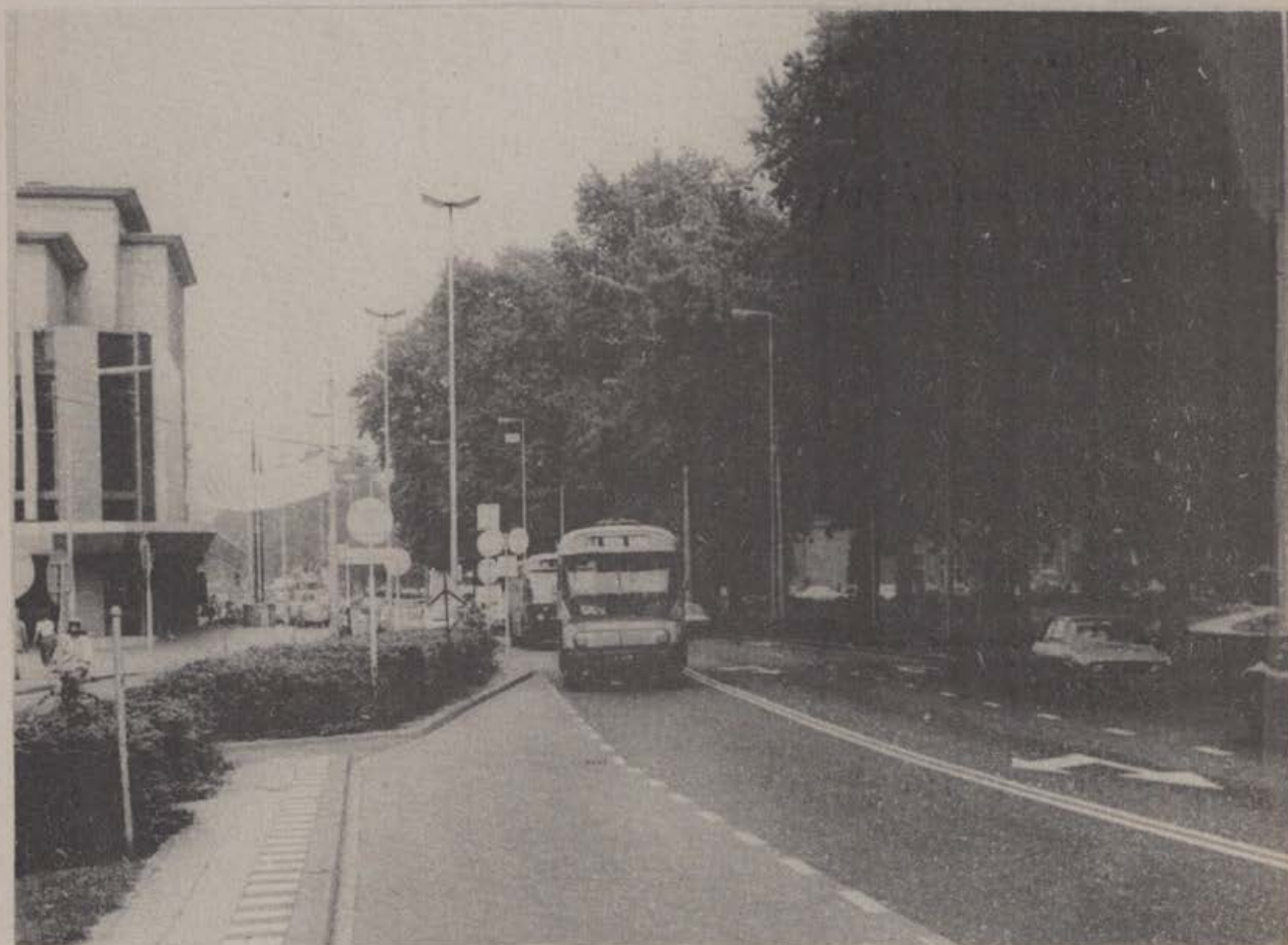
Eigen busbaan met halte naast de hoofdverkeersweg in Arnhem (Nederland)
